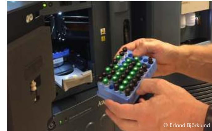
Vorbereitete Proben für die Analyse im LC-MS/MS
